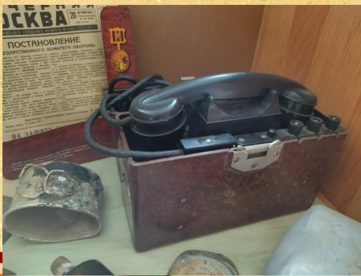
Военно-полевой телефонный аппарат системы МБ с индукторным вызовом
