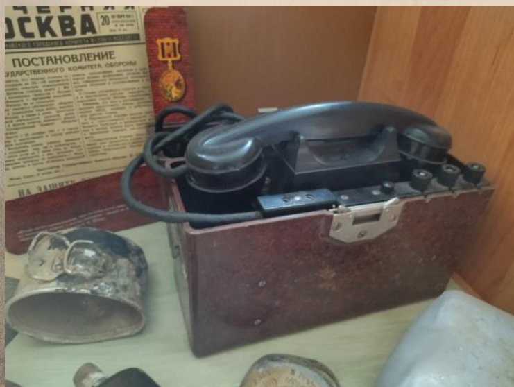
Военно-полевой телефонный аппарат системы МБ с индукторным вызовом
